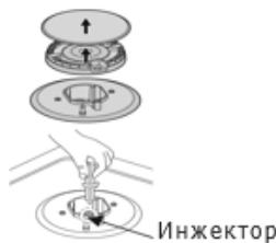
Снимите решетку, крышку конфорки и рассекатель пламени. Открутите инжектор, используя гаечный ключ на 7 мм, а затем установите вместо него инжектор, рассчитанный на подачу газа соответствующего типа. Аккуратно соберите все компоненты. После замены инжектор необходиомо надежно зафиксировать.
